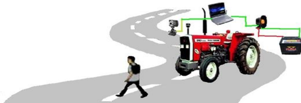
شکل ۱- سامانه بینایی ماشین برای تشخیص انسان در جلوی تراکتور
