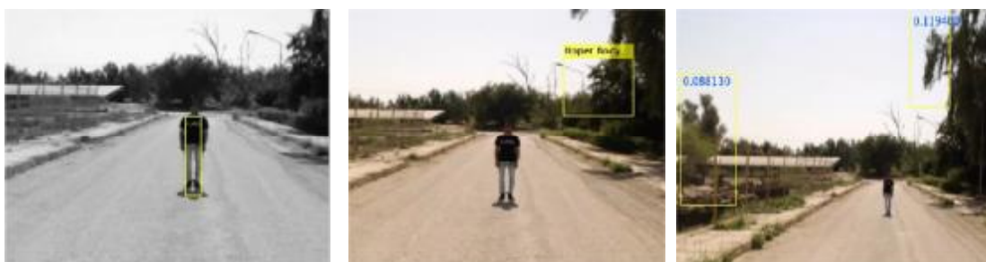
شکل ۱۱- شناسایی اشتباه در روش HOG (راست) و روش آبشار (وسط) و شناسایی صحیح در الگوریتم پیشنهادی (چپ)
