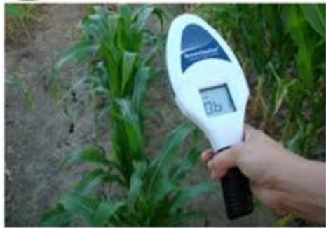
شکل ۱- حسگر GreenSeeker و نحوه به کارگیری آن در مزرعه
