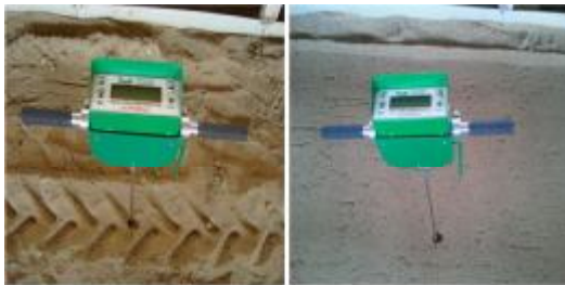
شکل ۳- اندازه‌گیری شاخص مخروط توسط نفوذسنج دستی Rimik cp20 الف- قبل از تردد ب- بعد از تردد
