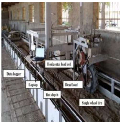
شکل ۱- آزمونگر تک‌چرخ، انباره خاک و تجهیزات وابسته
