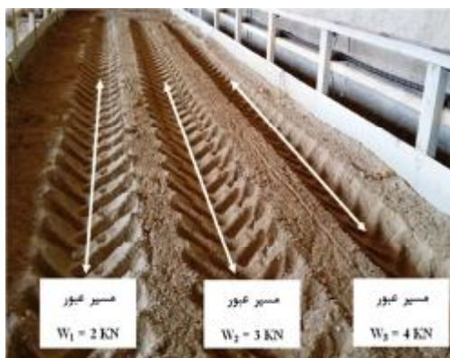
شکل ۴- رد شیار ایجاد شده در مسیر تردد چرخ برای سه سطح بار عمودی ۲، ۳ و ۴ کیلونیوتن
