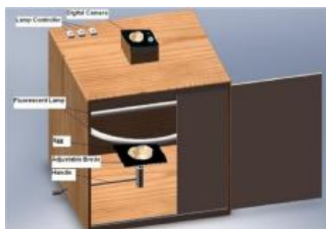
شکل ۱- محفظه تصویربرداری با نور قابل تنظیم به وسیله لامپ فلورسنت مدور (W ۴۰) و فاصله قابل تنظیم
