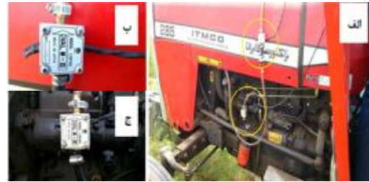
شکل ۳- حسگرهای سنجش جریان برای اندازه‌گیری مصرف سوخت (الف) نمای کلی، (ب) حسگر نصب‌شده در مسیر برگشت و (ج) حسگر نصب‌شده در مسیر رفت
