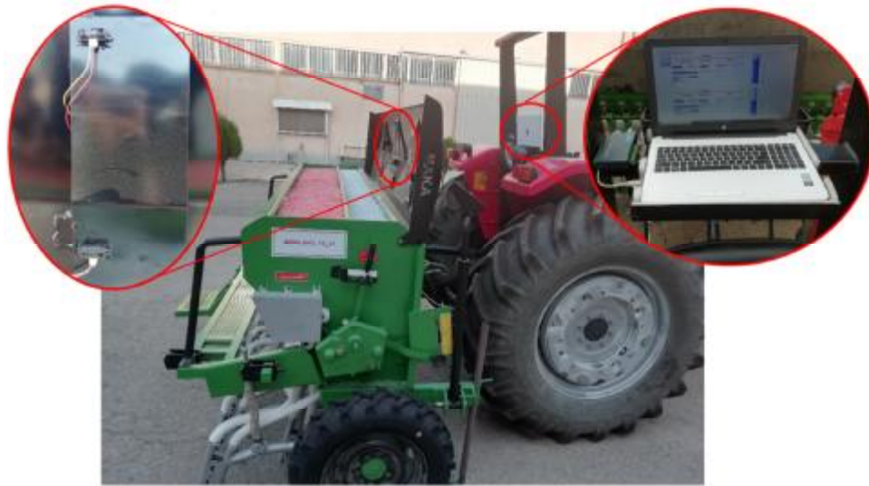
شکل ۶- پیاده‌سازی سامانه فاصله‌سنج بر روی خطی کار- کودکار
