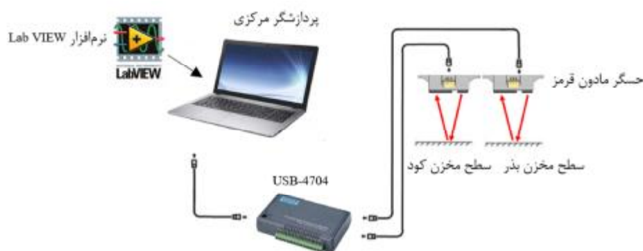
شکل ۴- شماتیک سامانه سطح‌سنج مادون قرمز
