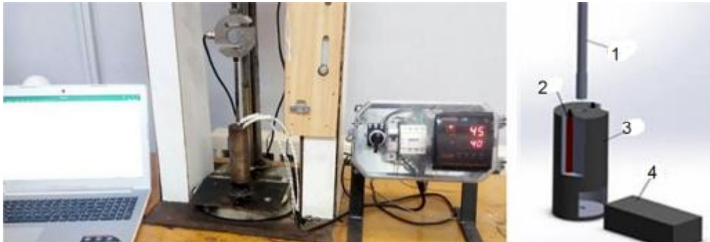
شکل ۲- مکانیزم پلت ساز و نحوه اتصال آن به دستگاه آزمون فشار (۱: پیستون فشاردهنده، ۲: المنت حرارتی یک عدد، ۳: بلوک سیلندر، ۴: پایه نگهدارنده متحرک
