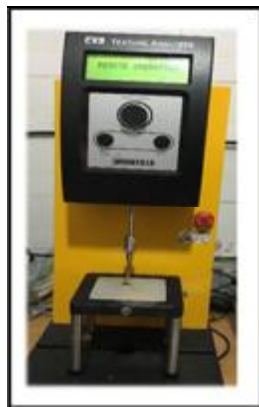
شکل ۳- دستگاه آزمون گر بافت، نفوذ کننده و نحوه قرارگیری پلت
