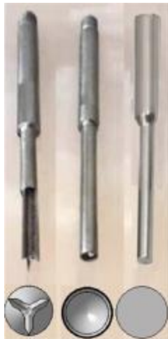
شکل ۳- انواع سنبه‌ها به همراه مقاطع از سر آنها (از راست به چپ: ساده، ساده تیغه‌دارگرد و سه‌پر)
