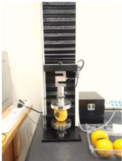
شکل ۱- بارگذاری خرمالوها و نحوه اجرای آن
