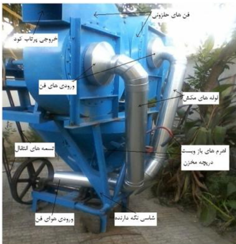
شکل ۱- دستگاه کودپاش بادی ساخته شده
