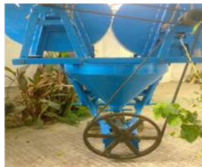
شکل ۴- الف) نحوه قرارگیری چرخ تسمه‌ها و ب) نمای افقی دستگاه کودپاش بادی به همراه وضعیت چرخ تسمه‌ها
