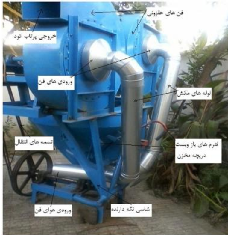
شکل ۱- دستگاه کودپاش بادی ساخته شده
