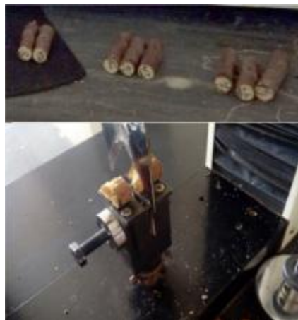
شکل ۲- نمونه‌های چوب و آزمون برش آنها در دستگاه
