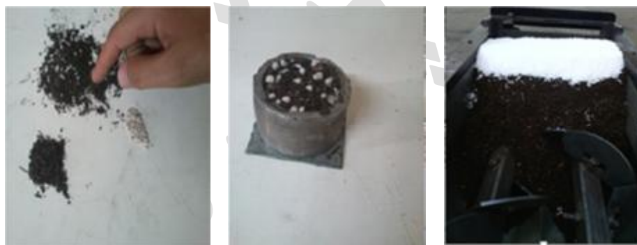
شکل ۴- روش انجام آزمایش الف) ریختن مواد داخل دستگاه، ب) نمونه برداری، ج) جدا کردن نمونه‌ها
