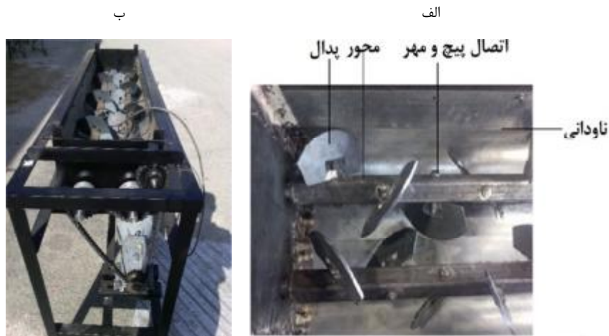
شکل ۲- نمای داخلی دستگاه: الف- پره‌های ساخته شده و نصب شده، ب- دستگاه ساخته شده
