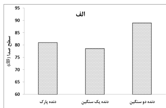
شکل ۲- میانگین‌های سطوح مختلف عامل نسبت دنده (الف) و عامل دور موتور (ب) بر سطح صدای منتشر شده از کمباین
