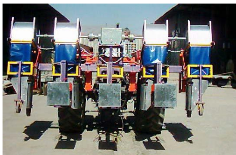
شکل ۱۲- تحمل وزن ماشین توسط اتصال سه نقطه
