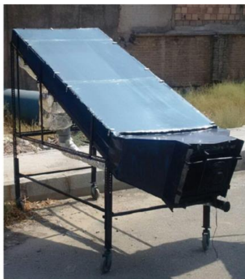
شکل ۳- جمع‌کننده صفحه تخت خورشیدی (Arabhosseini et al., 2019)
