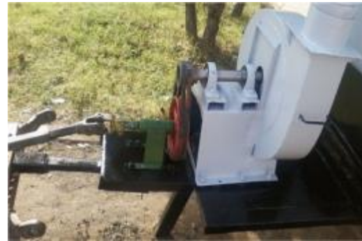
شکل ۳- سیستم انتقال قدرت با مکانیسم تسمه و پولی
