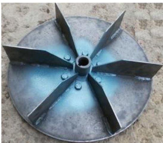
شکل ۶- نمونه پروانه بادزن با پره‌های شعاعی
