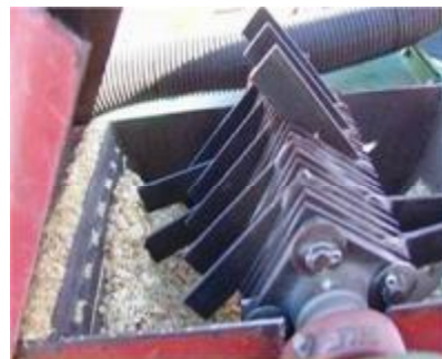
شکل ۱- نمای داخلی آسیاب چکشی
