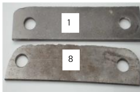
شکل ۹- مقایسه تیغه شماره ۱ (فولاد DIN X 210Cr12 کوئنچ در روغن) و تیغه شماره ۸ (فولاد DIN CK45 تیمار شاهد)
