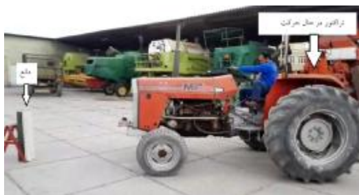
شکل ۷- آزمون ارزیابی عملکرد سامانه در تشخیص مانع و توقف تراکتور
