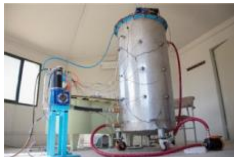
شکل ۵- سامانه رآکتور هاضم بی‌هوازی آماده کار
