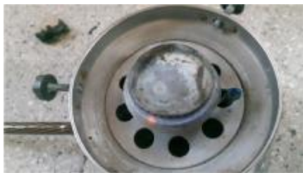
شکل ۷- تست شعله با بهره‌گیری از یک وسیله گاز سوز متعارف در پخت‌وپز
