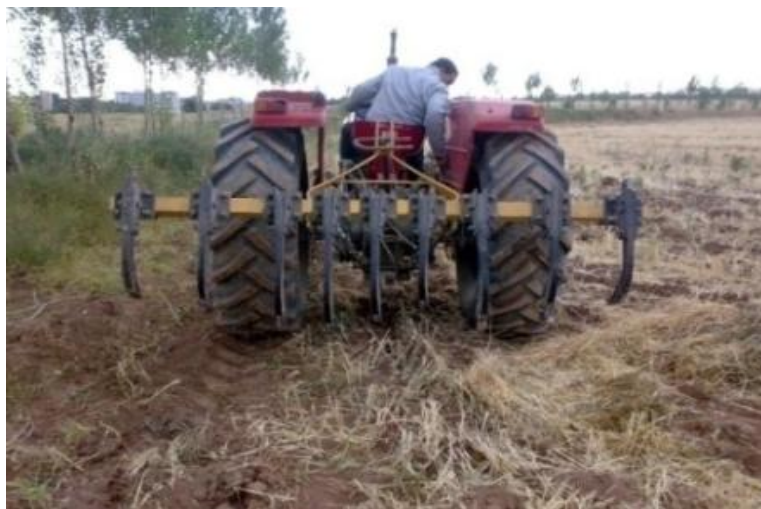
شکل ۲- شاسی با طول بازوهای متفاوت
