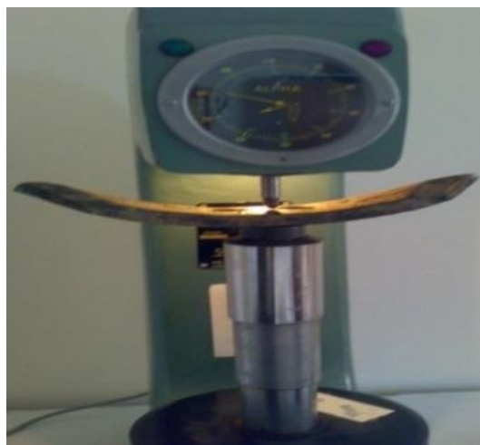
شکل ۱- اندازه‌گیری سختی تیغه با استفاده از دستگاه سختی سنج ALPHA
