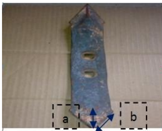
شکل ۳- اندازه‌گیری سایش تیغه در لبه و نوک تیغه
