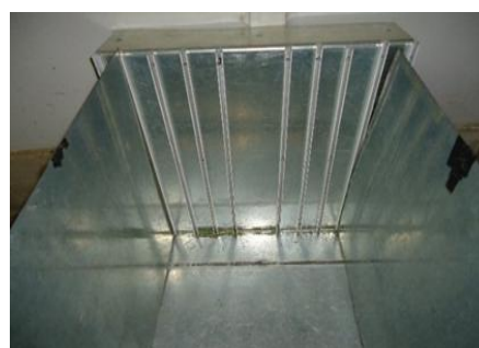
شکل ۱- نحوه نصب ناودانی‌ها در محفظه و قرارگیری صفحات خازن
