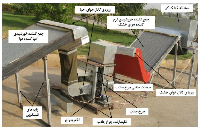
شکل ۱- نمایی کلی از دستگاه ساخته شده و نحوه ارتباط قطعات با یکدیگر
