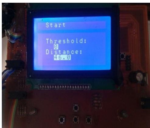
شکل ۶- برد طراحی شده با صفحه نمایشگر برای نمایش ارتفاع محصول
