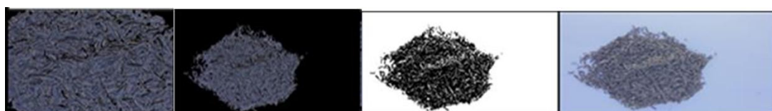
شکل ۵- فرآیند پیش‌پردازش تصاویر نمونه‌ها: (الف) تصویر رنگی، (ب) تصویر باینری، (ج) حذف نویز و پس‌زمینه و (د) تصویر نهایی برش خورده
