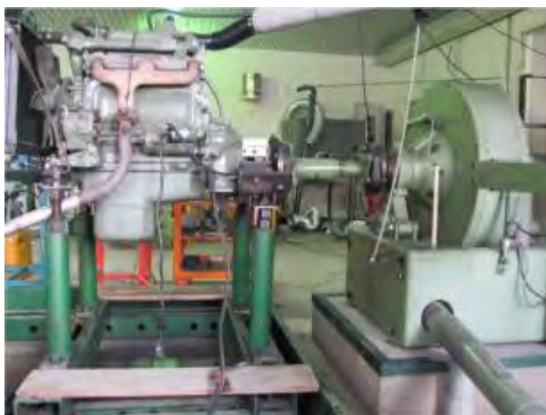
شکل ۱- دینامومتر مورد استفاده در آزمایش‌ها به همراه موتور تحت آزمایش (منظور همان موتور OM314)
