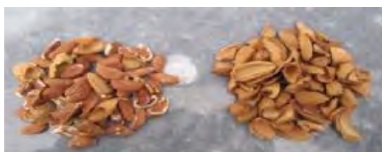
شکل ۳- محصول جداسازی شده بدون خطای جداسازی مغز الف: خروجی پوست ب: خروجی مغز
