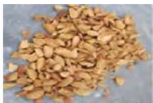
شکل ۱- مخلوط خروجی از دستگاه بادام شکن شامل مغز بادام و تکه‌های پوست چوبی
