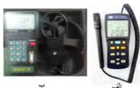
شکل ۲- دستگاه رطوبت‌سنج - الف) دماسنج و ب) دستگاه سرعت‌سنج پره‌ای جهت اندازه‌گیری سرعت هوا
