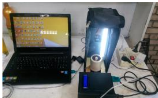
شکل ۳- طرح شماتیک و نمای سامانه تشخیص تقلب روغن زیتون
