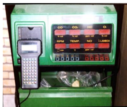
شکل ۲- دستگاه اندازه‌گیری آلاینده‌های موتور
