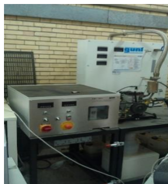
شکل ۱- مجموعه مورد نظر شامل موتور و دینامومتر
