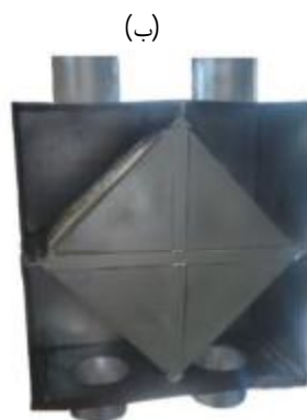
شکل ۲- مبدل حرارتی: الف- طرح‌واره نشان‌دهنده مسیر حرکت سیال‌ها؛ (ب) تصویر مبدل ساخته شده
