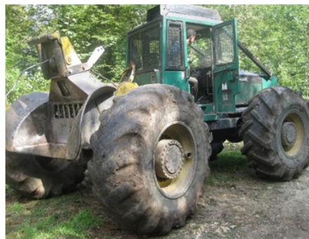
شکل ۱- تصویر اسکیدر Timberjack 450C
