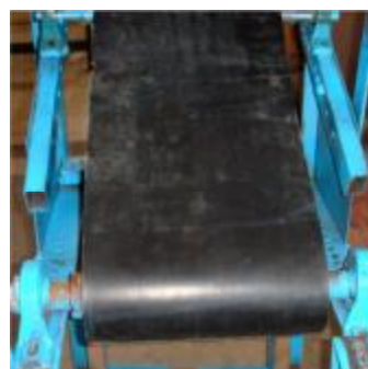
شکل ۲- سطح شیب‌دار انتقال قلمه به موزع
