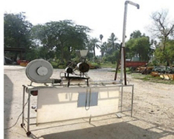
شکل ۱- سیستم انتقال نیوماتیک عمودی ذرت، (۱) الکتروموتور، (۲) دمنده، (۳) موتور موزع، (۴) موزع، (۵) مخزن موزع، (۶) فشارسنج، (۷) زانویی اول، (۸) زانویی دوم، (۹) زانویی سوم، (۱۰) لوله‌های انتقال، (۱۱) مانومتر
