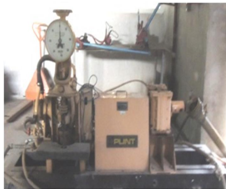
شکل ۱- دینامومتر مورد استفاده جهت اندازه گیری گشتاور
