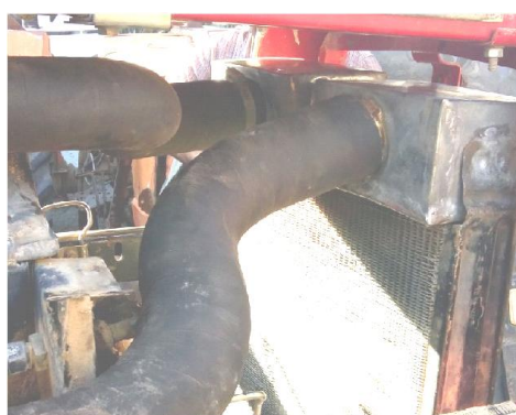
ب) لوله های ورودی و خروجی اینترکولر
