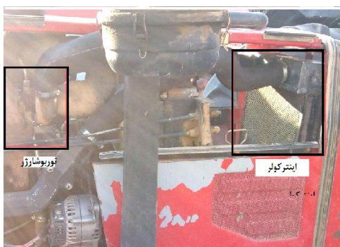
الف) محل استقرار توربوشارژر و اینترکولر
