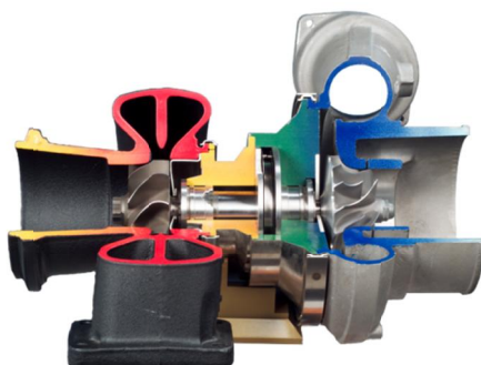
شکل ۲- توربو شارژر برش خورده مورد استفاده
