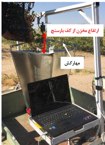
شکل ۱- دستگاه سنجش عملکرد محصول پسته در برداشت دستی
