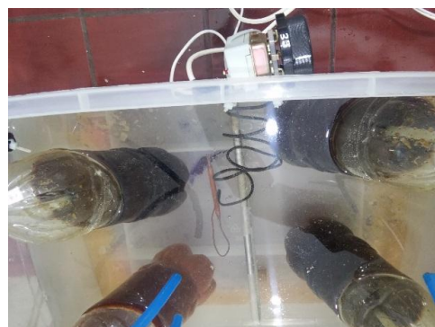
شکل ۱- نحوه قرارگیری گرمکن و ترموستات درون حمام
