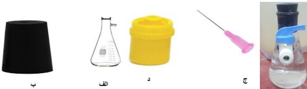
شکل ۴- الف) ارلن خلاء، (ب) درپوش الاستیکی، (ج) نیدل، (د) هیپارین لاک (صفربند انژیوکت)، (و) یک واحد کامل شده هاضم بی‌هوازی
