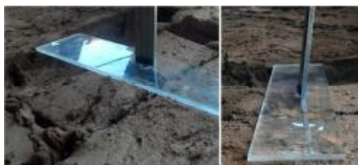
شکل ۳- اندازه‌گیری فرورفتگی به کمک کولیس و صفحه پلکسی
