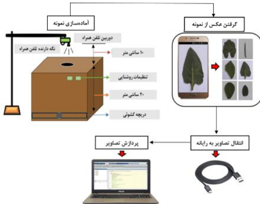
شکل ۲- طرح واره سامانه بینایی ماشین مورد استفاده برای تصویربرداری از گیاهان دارویی
