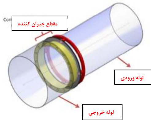
شکل ۲- مکانیزم لوله با مقطع واگرا
