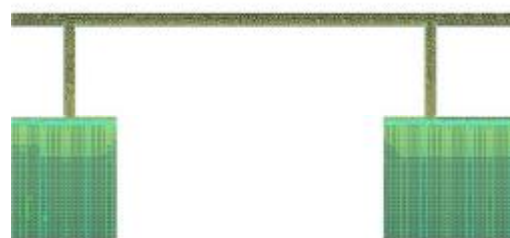
شکل ۵ - مش‌بندی صفحه پلی‌کربنات در حالت موازی. در شکل فقط بخشی از دو صفحه پلی‌کربنات نشان داده شده است.
