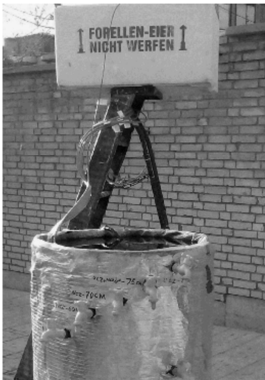
شکل ۳- نحوه قرارگیری لوله های خارج ساز و تزریق آب در استخر خورشیدی
