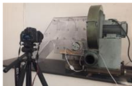
شکل ۴- سیستم تصویربرداری و مسیریابی غلات
