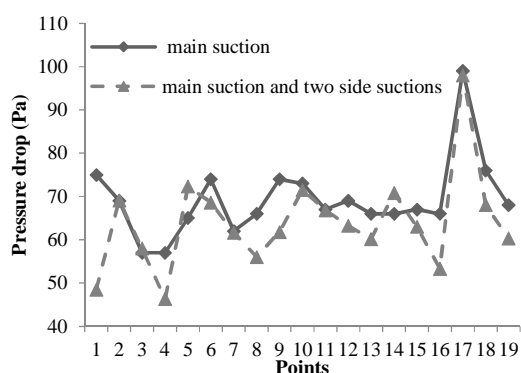
شکل ۸- مقایسه افت فشار در داخل محفظه ته‌نشینی
