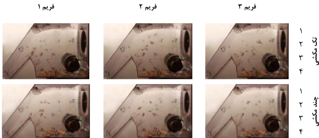
شکل ۶- جریان مواد: محفظه تک مکشی (ردیف بالا)، محفظه چند مکشی (ردیف پایین)
