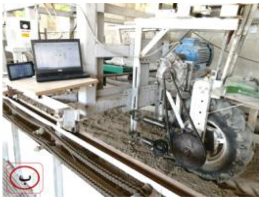
شکل ۱- آزمون‌گرها و انباره خاک مورد استفاده در آزمون‌های تجربی: الف) آزمون‌گر تک‌چرخ شنی فولادی، ب) آزمون‌گر تک‌چرخ معمولی
