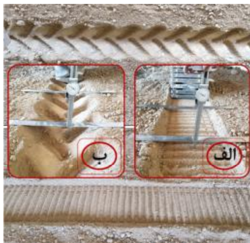
شکل ۳- اندازه‌گیری نشست خاک در زیر چرخ‌ها: الف) چرخ شنی فولادی، ب) چرخ معمولی
