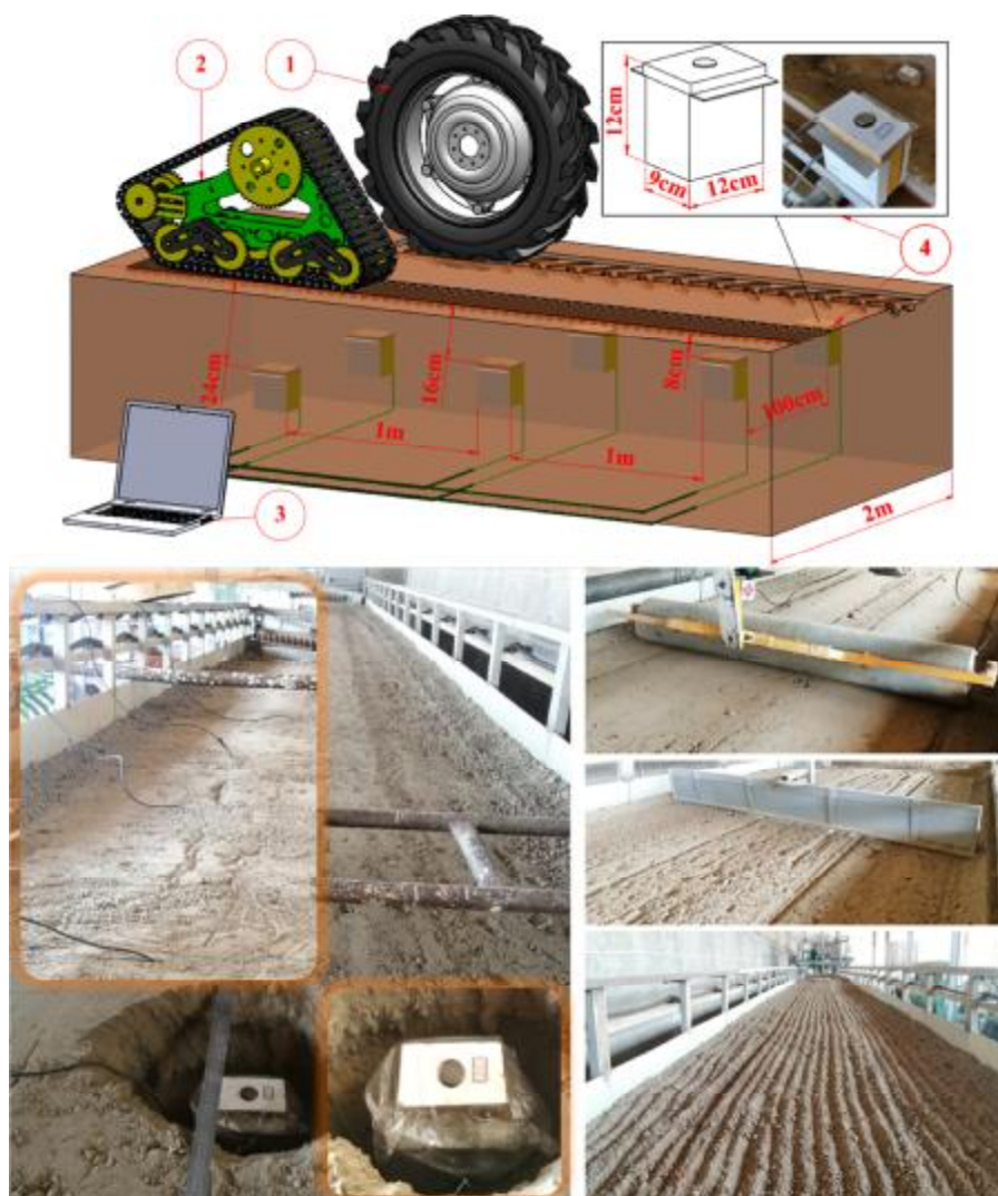
شکل ۲- سامانه اندازه‌گیری تنش عمودی در خاک: ۱- چرخ بادی، ۲- چرخ شنی، ۳- داده‌بردار و ذخیره‌کننده اطلاعات حسگرهای نیروسنج و ۴- نیروسنج‌های دفن شده در عمق‌های مختلف خاک
