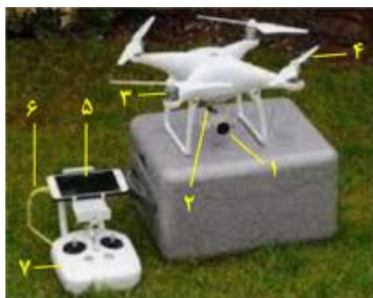
شکل ۱- کوادکوپتر مدل DJI Phantom 4: ۱) دوربین، ۲) لرزش گیر، ۳) موتور الکتریکی، ۴) ملخ، ۵) گوشی هوشمند، ۶) کابل اتصال گوشی به کنترل ۷) دستی کنترل
