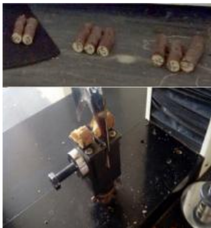
شکل ۲- نمونه‌های چوب و آزمون برش آنها در دستگاه
