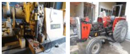
شکل ۱- دینامومتر اصطکاکی - هیدرولیکی (چپ) و تراکتور ITM285 (راست)
