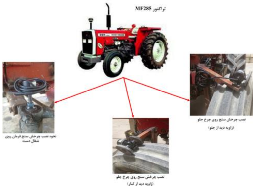
شکل ۳- نحوه نصب چرخش سنچ‌ها روی تراکتور MF285
