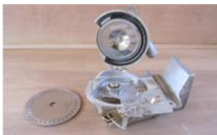
شکل ۳- موزع پنیوماتیک و صفحه موزع آن (Mondani & Karparvarfard, 2016)
