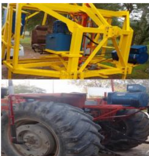
شکل ۲- الف) اتصال ژنراتور با پولی و تسمه به پی تی او (Goudarzi et al., 2015) و ب) اتصال با کوپلینگ و شفت و ۴ شاخه گاردان (Kazemi et al., 2018)
